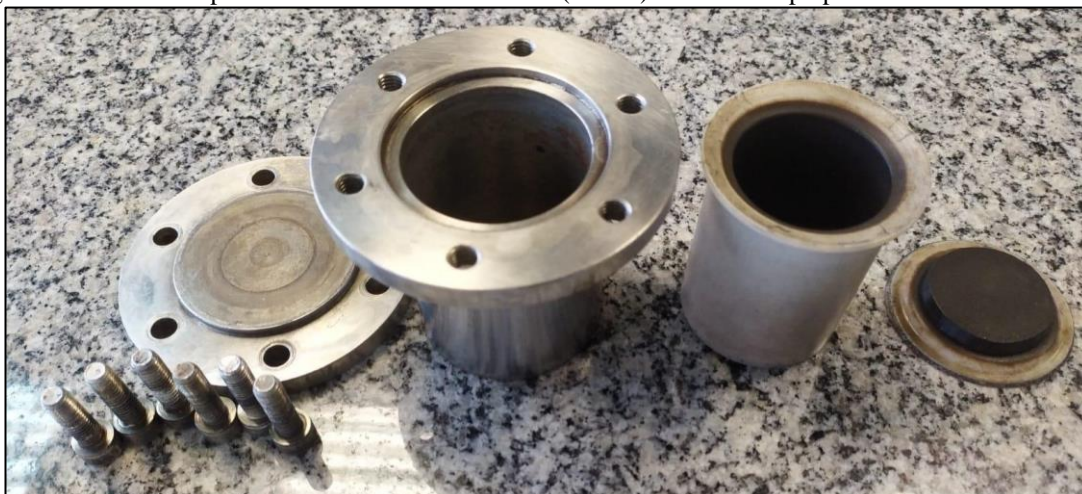
Figura 3.1 Reator do tipo autoclave com vaso de teflon (80 mL) utilizado no preparo dos carvões sulfonados.
